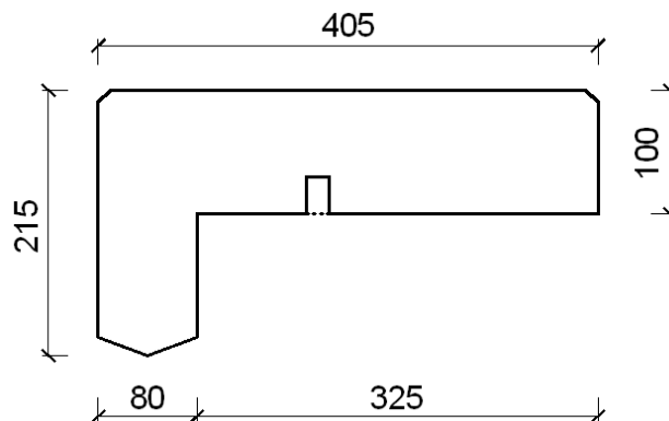
Rys. 2. Betonowa kapa kryjąca
